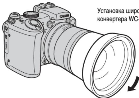
Установка широкоугольного конвертера WC-DC58A
